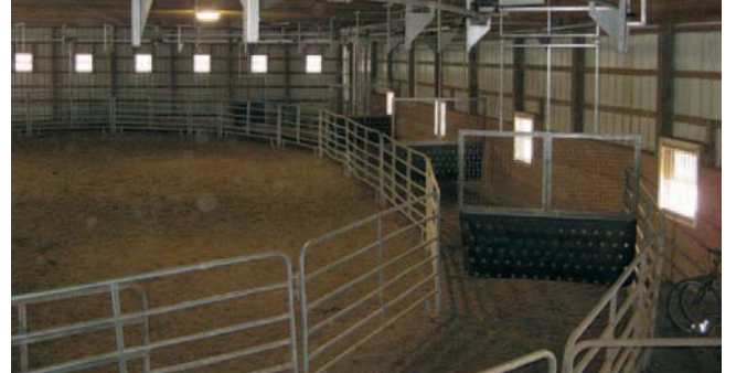
Marcheur Entreprise ovale 15 x 30 m, pour 12 chevaux, monté dans un manège existant. Ecurie Bookmann, Acron Ohio (USA)
